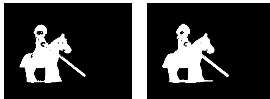
Figura 5.11 A la izquierda segmentación usando YUV normalizado. A la derecha con un cambio de iluminación
