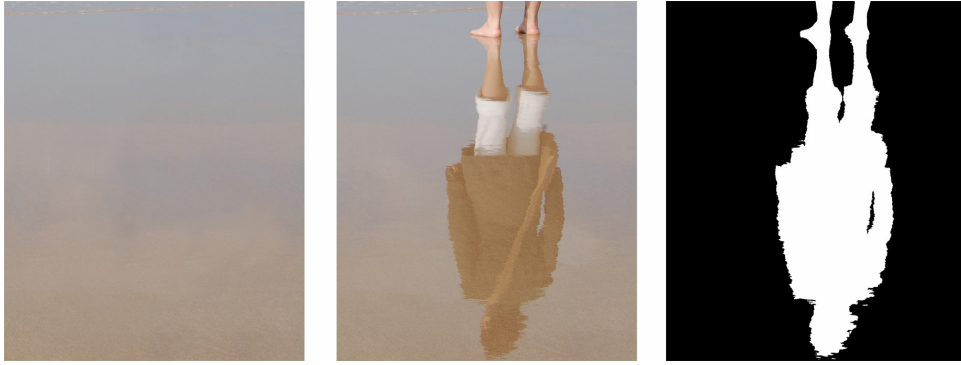
Figura 5.4 Segmentación de fondo con reflexiones debido a superficie mojada
