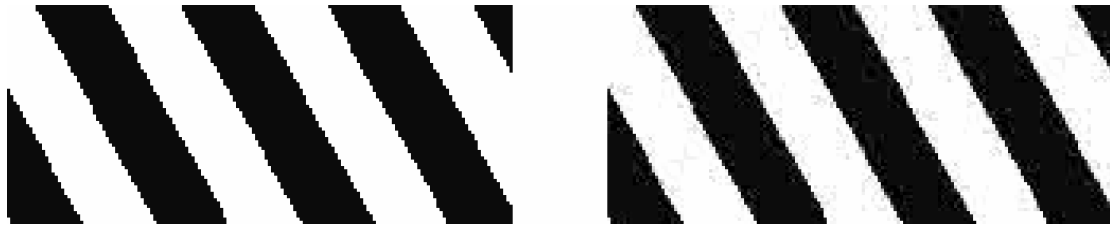
Figura 7.8 Bordes antes (izquierda) y después (derecha) de la compresión JPEG
