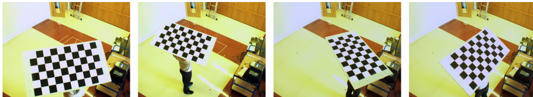
Figura 3.10 Cuatro capturas del patrón de calibración para parámetros intrínsecos
