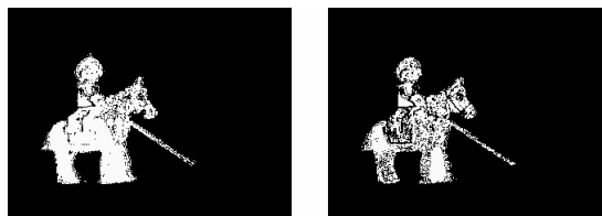
Figura 5.14 A la izquierda segmentación de fondo usando espacio invariante a la iluminación. A la derecha con un cambio de iluminación
