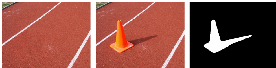
Figura 5.3 Sombras en la imagen. A la izquierda la imagen de referencia. En el centro se añade un objeto. A la derecha el resultado de la segmentación
