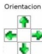
Figura 4. 4 - Flechas incluidas en la ventana del comportamiento "Movimiento Básico" que se utilizan para fijar la orientación del robot en el destino
